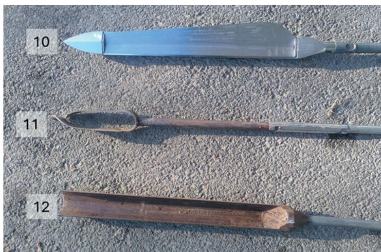
Matériel pour prélèvement de sol en tourbière. Le trou résultant du prélèvement peut être utilisé pour placer le tube du piézomètre et son dispositif d'ancrage. 10 : carottier russe, 11 : tarière Edelman, 12 : tarière gouge
