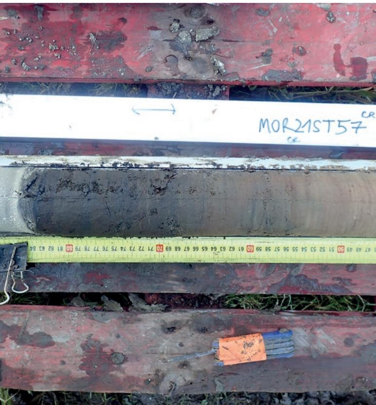
*A gauche : haut - L'utilisation d'un carottier russe, mécanisé, permet à l'équipe de remonter des prélèvements jusqu'à plusieurs mètres de profondeur*
